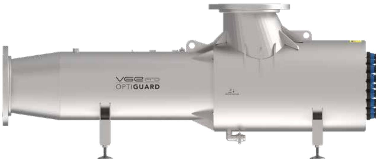
La cámara de tratamiento está fabricada en acero inoxidable 316L, que no solo refleja la radiación UV-C, sino que también garantiza una presión máxima de 12 bar, lo que asegura una durabilidad y fiabilidad a largo plazo.
