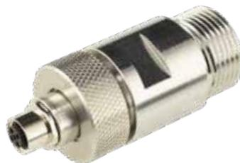
Sensor UV INOX en ventana de medición, el sensor se utiliza en combinación con los sistemas OptiGuard. El sensor UV se coloca dentro de una ventana de medición que mira hacia el interior de la cámara de tratamiento. La ventana puede soportar una presión de agua de hasta 16 bar y el sensor UV se puede retirar de la ventana sin necesidad de vaciar la cámara de tratamiento. Funciona igual que el sensor UV INOX.
