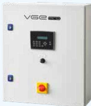
Le régulateur confort est un régulateur complet pour l'unité moyenne pression 600-85 ou 1200-85. Le régulateur peut être équipé en option d'un capteur UV pour mesurer l'intensité des UV-C à l'intérieur de la chambre de traitement. En outre, il convient à un capteur de température ou à un ModBus. Le capteur de température surveille la température dans la chambre de traitement pour éviter la surchauffe. Le régulateur est disponible en différentes langues.
